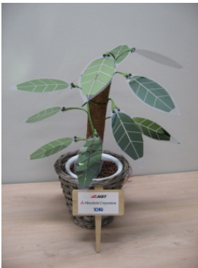
リーフ状有機薄膜太陽電池: 産業技術総合研究所、三菱商事殿、トック殿共同研究の成果です。
